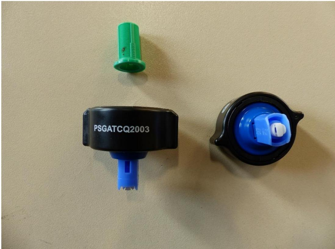
**Doppelflachstrahldüse John Deere PSGATCQ2003**
